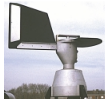
Les capteurs de pollen du RNSA (type HIRST) : ils simulent la respiration humaine (Photo : RNSA)
